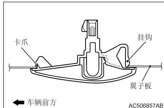
使钩子钩住翼子板以安装侧转向信号灯。
